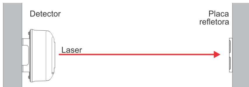
Certifique-se que o detector e o seu respectivo espelho estejam alinhados, na mesma altura e direção para não haver dificuldades durante o processo de ajuste do alinhamento do detector.
