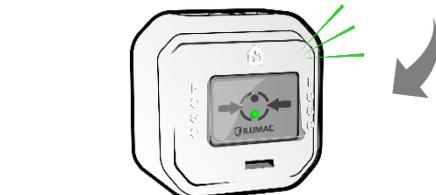
**3** – Para rearmar o dispositivo, insira a chave no orifício e realize um giro de 90° no sentido-horário, retire a chave, vá até a central e reinicie o sistema para retornar ao sistema normal.
