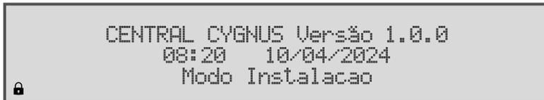
Com o modo instalação desativado, a central verifica o estado de todos os dispositivos configurados e indica caso algum deles seja removido. Após a entrega do sistema, o modo instalação deve ser mantido desativado.
