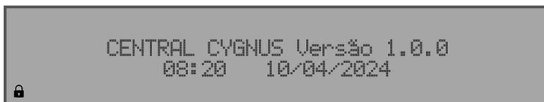
Após todas as checagens de suas condições funcionais, e, obtendo êxito, a central acenderá o LED de transmissão, acenderá o LED de alimentação e o display exibirá o ícone de um cadeado, indicando que o teclado está bloqueado.
