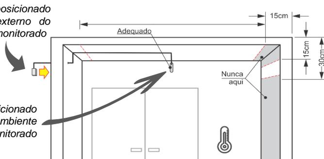
1 Exemplo de posicionamento do detector TDPW-C com sensor interno no ambiente à monitorar.
