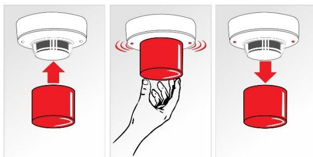
**ATENÇÃO:** O excesso de uso pode contaminar as paredes internas da câmara óptica e influenciar na reflexão do infravermelho, causando disparos falsos no detector. Caso isso aconteça o teste deverá ser interrompido e aguardar aproximadamente 10 minutos para retomar os testes, garantindo que as partículas acumuladas nas paredes internas da câmara óptica evapore.
