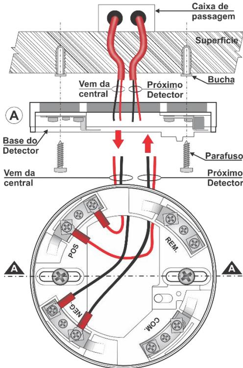
O sistema **Sirius** utiliza cabo de duas vias, sendo **vermelho positivo (L+)** e **preto negativo (L-)**. O dreno deve ser emendado e muito bem isolado, bem como deve isolar a malha do cabo no limite do decape. Utilize terminais para garantir a segurança e uma boa conexão nos bornes.
