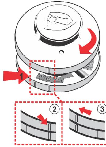
1 – Para encaixar corretamente o detector na base, verifique na lateral a indicação de **um retângulo** no detector, e **um retângulo** na base.
