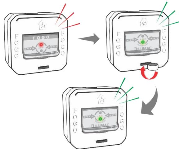
**3** – Para rearmar o dispositivo, insira a chave no orifício e realize um giro de 90° no sentido-horário, retire a chave, vá até a central e reinicie o sistema para retornar ao sistema normal.
