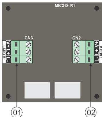
**01** – Borne para a conexão da **continuação** do laço da rede endereçável e/ou alimentação V+;
