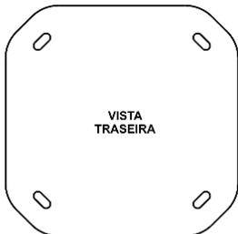
Para a fixação, utilize parafusos e buchas adequados ao material da parede que ele será fixado (não acompanha o equipamento).
