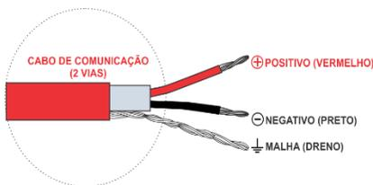
O cabo de comunicação é o elemento fundamental para interligação dos dispositivos da rede endereçável à central e é de suma importância para a qualidade e eficácia do funcionamento do sistema. Por isso, só utilize os cabos com a as especificações técnicas recomendadas pela ILUMAC.
