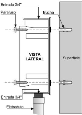
Para a fixação, utilize parafusos e buchas adequados ao material da parede que ele será fixado (não acompanha o equipamento).
