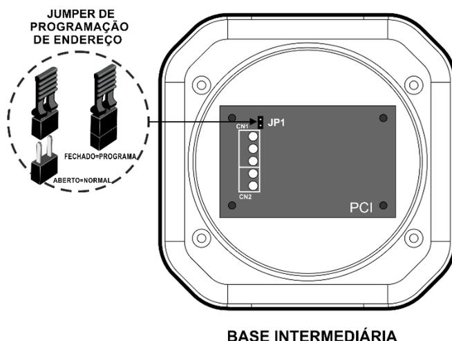
**ATENÇÃO:** Se o jumper de programação não for retirado, ou seja, for mantido FECHADO, o dispositivo não irá se comunicar com a central durante o funcionamento normal de supervisão do sistema.
