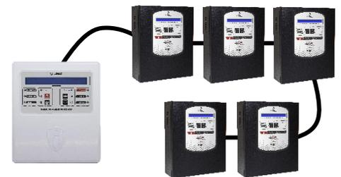
Permite o uso de painel supervisor principal PSM-D para verificação e controle de até 5 centrais SIRIUS-MAX II por uma sub rede via RS485, permitindo a supervisão de até 4.995 endereços, de acordo com os modelos adquiridos. É necessário o uso do módulo MCL-485 em cada central (adquirido separadamente).
