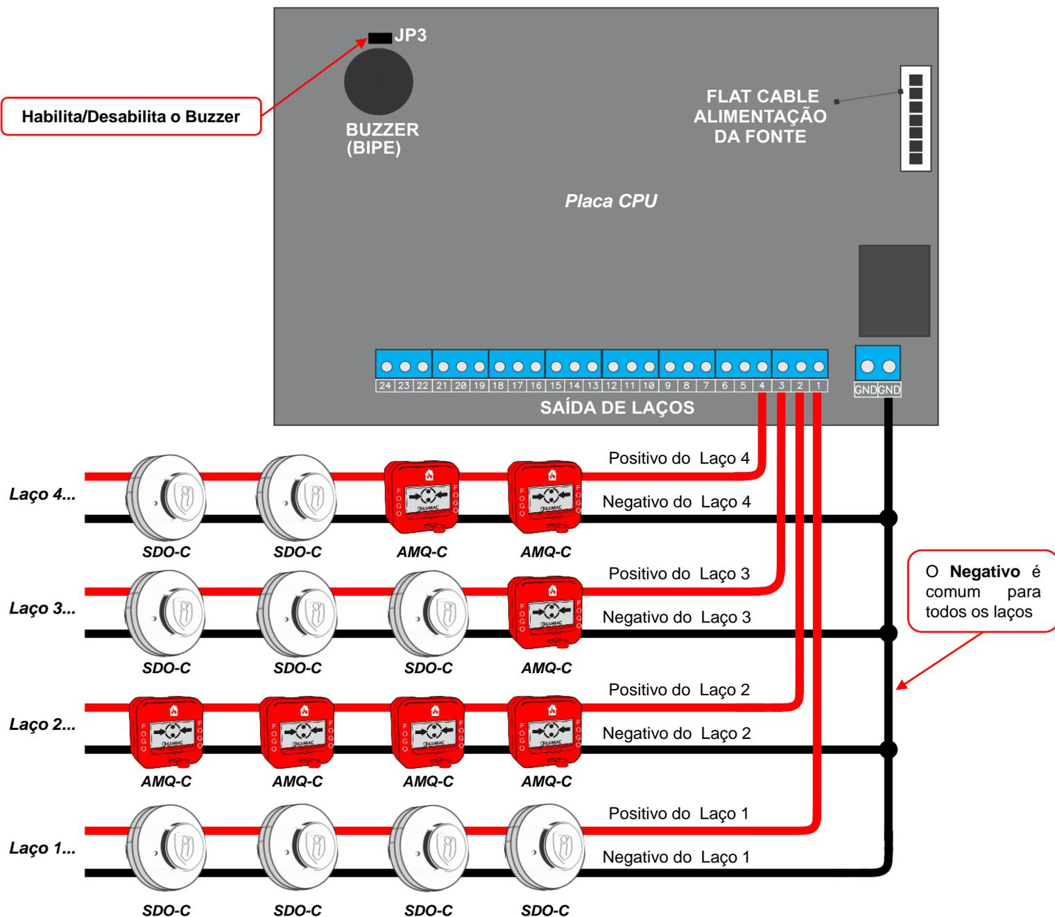
**ATENÇÃO:** Esta central funciona por controle de corrente, ou seja, quando um dispositivo é acionado, a tensão cai devido ao aumento de corrente no dispositivo, com um consumo máximo de 22mA.
