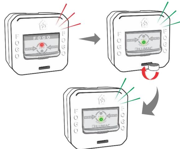
**3** – Para rearmar o dispositivo, insira a chave no orifício e realize um giro de 90º no sentido-horário, retire a chave, vá até a central e reinicie o sistema para retornar ao sistema normal.
