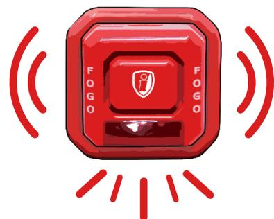
**2** - Assim que a sirene receber o comando de alarme vindo da central, ela começará a tocar e piscar seus leds frontais, indicando perfeito funcionamento.
