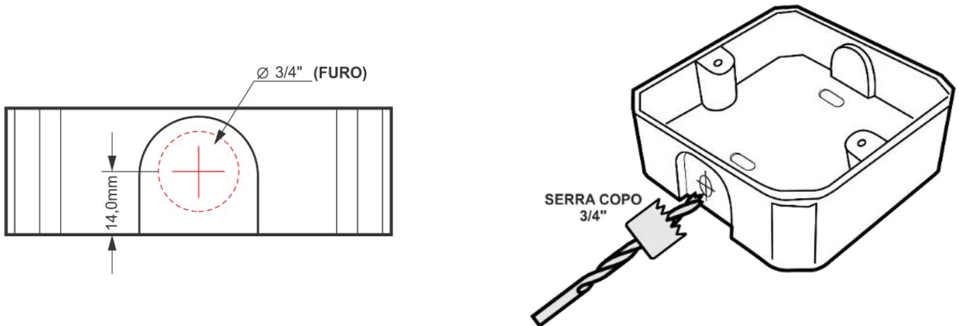
**ATENÇÃO:** cuidado ao realizar a furação da caixa. Retire a base onde está localizada a placa eletrônica do dispositivo para evitar danos durante o processo de furação.
