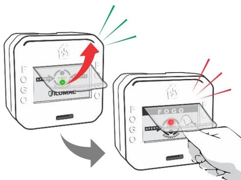
**3** – Para rearmar o dispositivo, insira a chave no orifício e realize um giro de 90° no sentido-horário, retire a chave, vá até a central e reinicie o sistema para retornar ao sistema normal.
