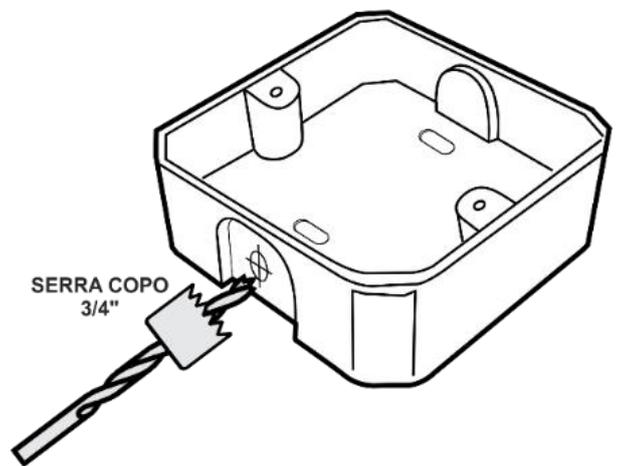
**ATENÇÃO:** cuidado ao realizar a furação da caixa. Retire a base onde está localizada a placa eletrônica do dispositivo para evitar danos durante o processo de furação.
