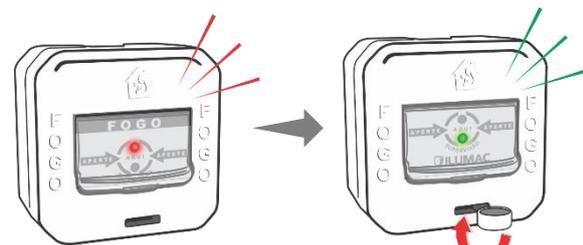
**2** – Para acioná-lo, levante a tampa de proteção e faça uma pressão no local indicado para que o mecanismo trave. Verifique se o led de "fogo" acendeu, bem como verifique a sua sinalização no display da central de alarme.
